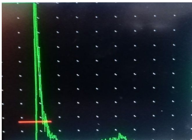
شکل ۴. نمودار A-scan مربوط به سیستم بدون جایگذاری قطعه
